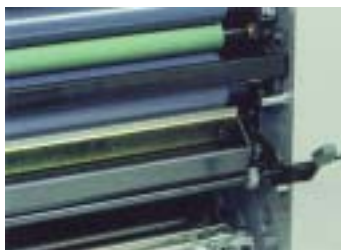
Устройство смывки красочного аппарата
